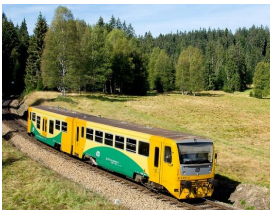
Dříve nasazovaná motorová jednotka řady 814, která vychází z motorového vozu řady 810, foto: Zelpage.cz
