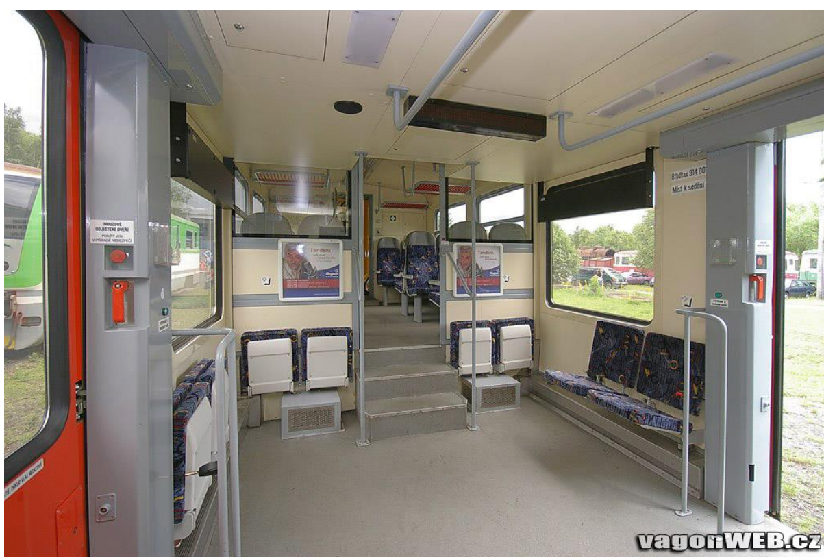
Motorová jednotka řady 814 – interiér nízkopodlažní části, která je využívána cyklisty, ačkoli není vybavena háky na kola
